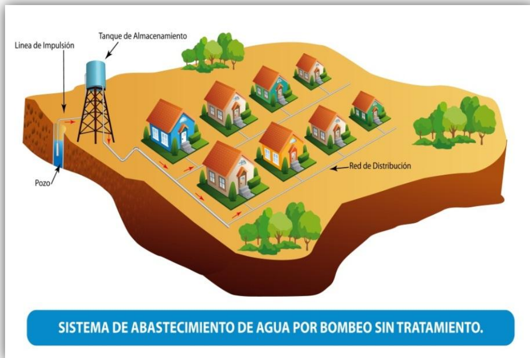
Figura 8. Sistema de agua con bombeo sólo desinfección
