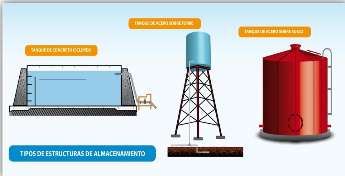
Figura 5. Tipos de tanques de almacenamiento
