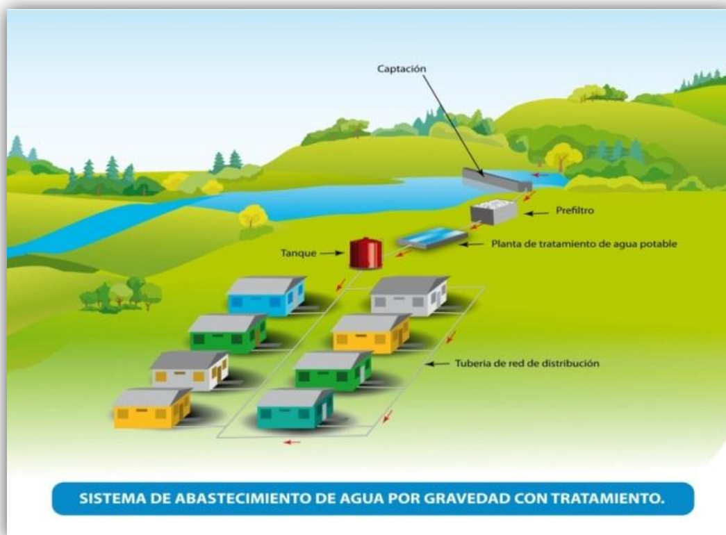
Figura 7. Sistema por gravedad con planta potabilizadora
